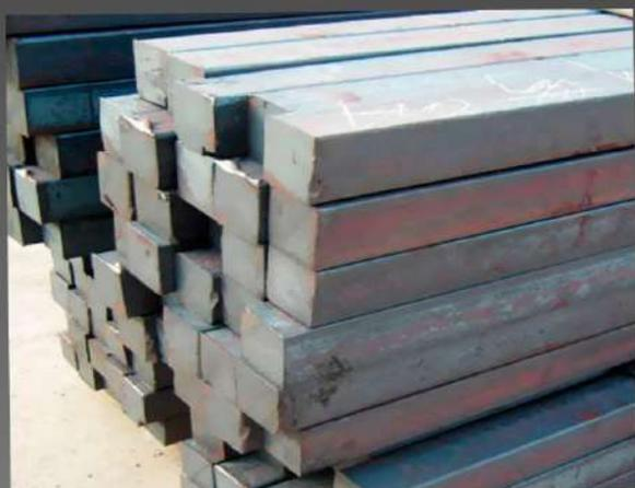
Квадрат стальной — это металлический сплошной профиль квадратного сечения толщиной от 6 до 200 миллиметров без полой внутренней области, в металлопрокате именуют, как прокат квадратный или просто квадрат.
