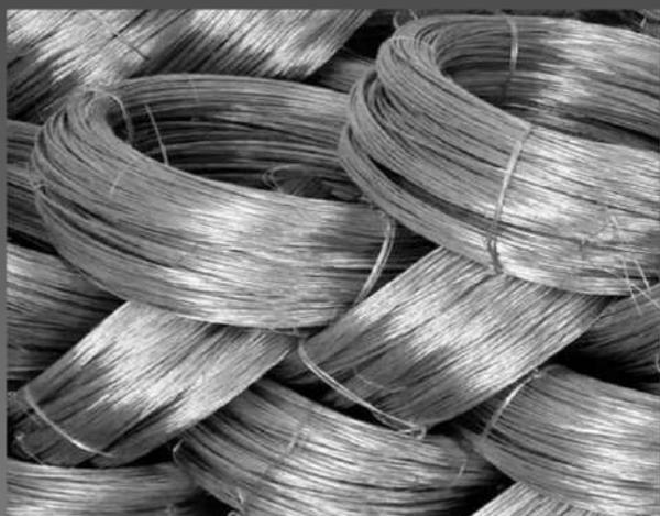
Проволока – вид металлопроката, представляющий собой металлическую нить круглого сечения и различного диаметра. Для изготовления проволоки могут использоваться различные сорта и виды металла, область применения зависит от материала изготовления. Наиболее востребованы стальная, медная, алюминиевая проволока.
