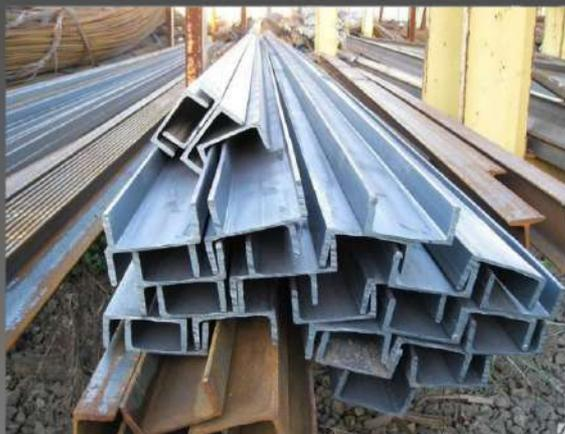
Швеллер - это конструкция из металла П - образной формы, которая широко используется в строительных работах, в машиностроении, как опорный элемент при возведении мостов.
