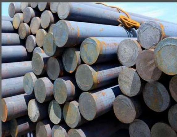
Стальной круг – тип металлопроката, выполненный в виде стального прута со сплошным круглым сечением. Благодаря разнообразию ассортимента, простоте обработки и недорогой стоимости материала прут широко применяется в машиностроительной отрасли и производстве станков.
