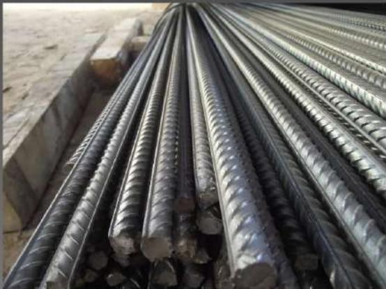
Арматура – это металлическое изделия в виде стержня. Арматурные прутья относят к важным элементам строительства. Она используется во всех видах железобетонных конструкций для предотвращения растяжения плит и появления трещин, повышения прочности к нагрузкам.
